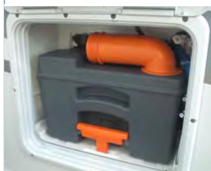
Cassette WC en service
